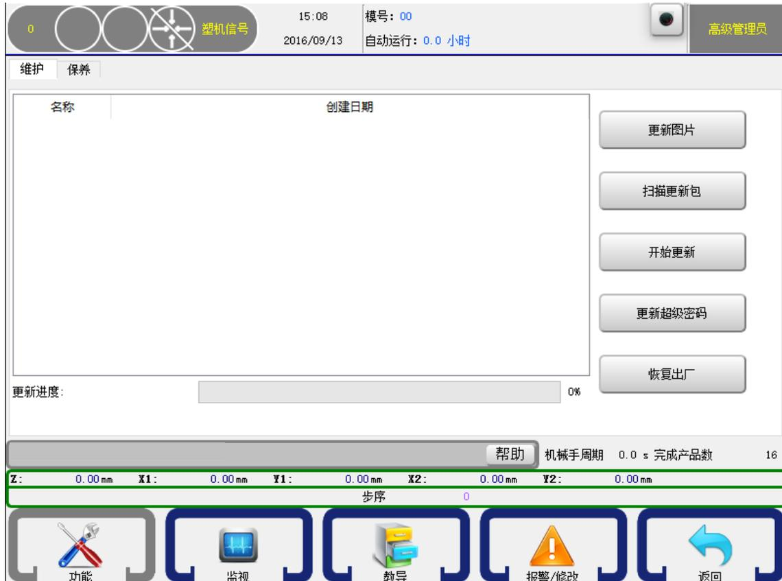
升级说明：将升级程序拷入 U 盘，手控器上电后插入 U 盘，登录高级管理员，旋钮选择停止，进入功能——维护，点击扫描更新包，出现版本号后，选择该版本，之后点击开始更新。系统会自动重启，然后拔出 U 盘。
