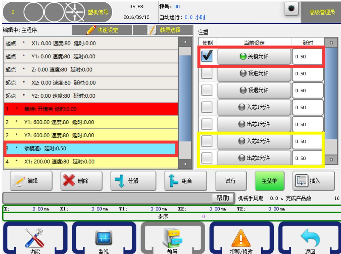
控制器可控制五组（标准程序）注塑机信号动作，点击所要控制动作，该注塑机信号动作即输出同时按钮上的指示灯即变成绿色。再点击左边的使其变成，再点击【插入】按钮将该动作插入到所选择程序步的前面。
