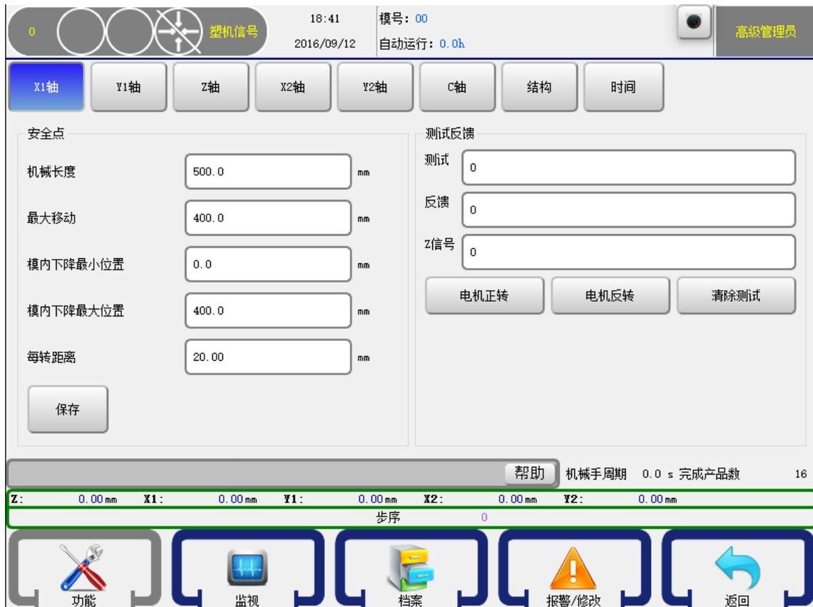
机械长度：设定各伺服轴机械结构的长度。**【警告：此项修改可能导致机器出现故障】**
