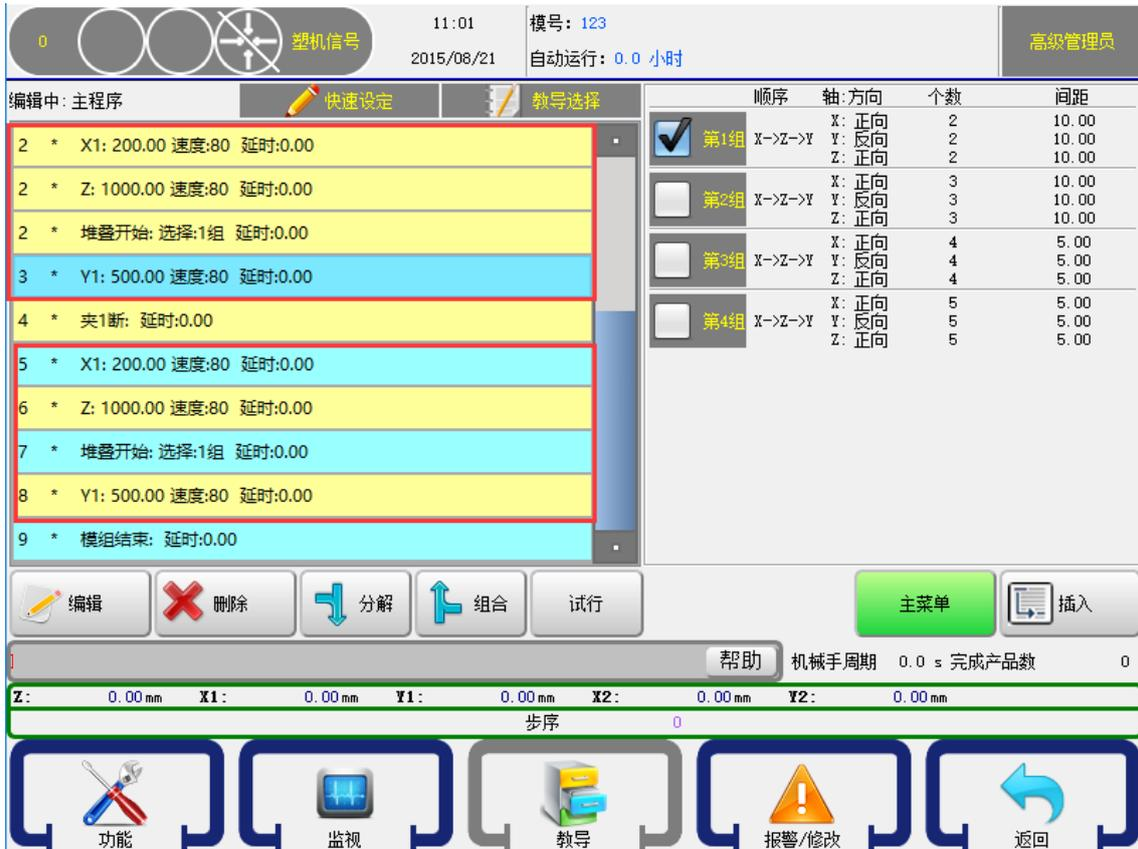
选中要插入的堆叠程序组左边的方框，如选择第 1 组堆叠程序，再点击【插入】按钮将该组堆叠程序插入到要开始堆叠的程序步前，自动运行时，机械手即按照此堆叠程序摆放排放产品。如果要使用 Y 轴进行堆叠时，务必将堆叠程序插入到 Y 轴下降动作的前一步。
