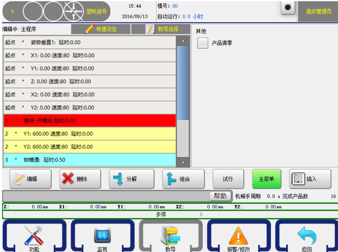
产品清零：当插入到程序里面，执行到这一步时，系统会将完成产品数置零，重新开始计数。一般配合子程序来使用。
