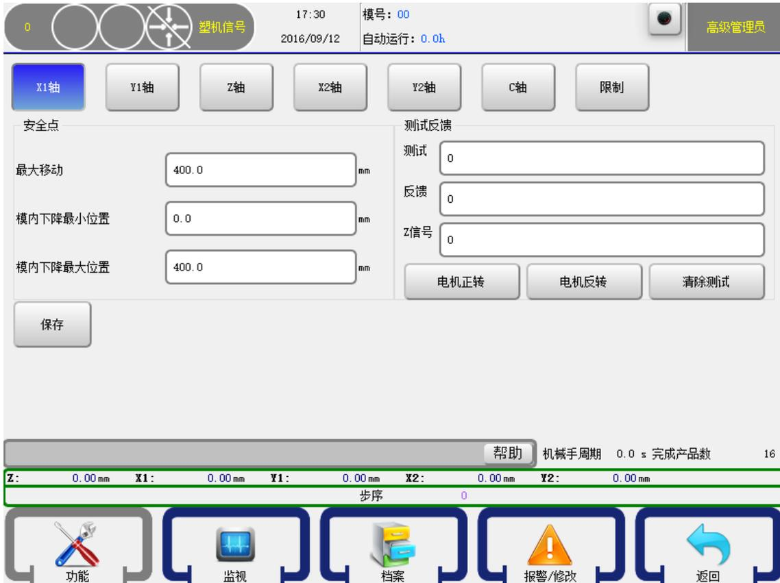
电机正反转是测试电机方向,即确认归原点方向的重要措施。属于调试机器的第一步。所有轴的反转方向即为归原点方向。
