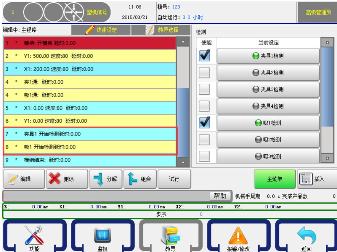
点击【检测】按钮可进入吸盘、夹具检测动作的教导页面，教导夹具和吸盘的动作后，点击需要检测确认信号的程序步后，再点击对应的夹具和吸盘检测动作按钮，使其指示灯变成绿色，再点击使其变成，再点击【插入】按钮将该检测程序插入到所选择程序步的前面，程序从此步开始检测夹具和吸盘的确认信号。
