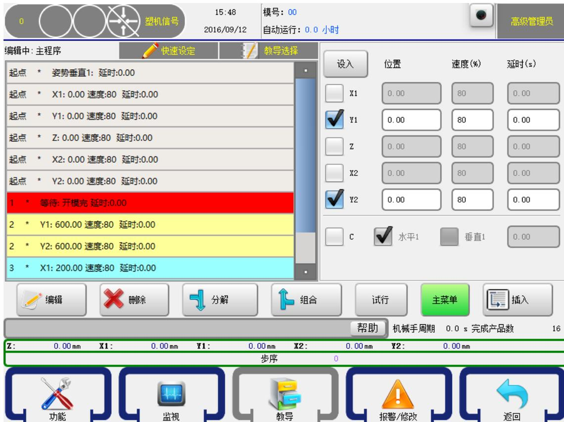
在该页面可对 X1 (X2)、Y1(Y2)、Z 等伺服轴的位置、动作速度、延时时间进行设定，点击轴左边的  使其变成图标 ，然后设定好该轴的参数，选中页面左边的程序步，再点击【插入】按钮即可将所编辑的轴动作插入到所选中程序步的前面。
