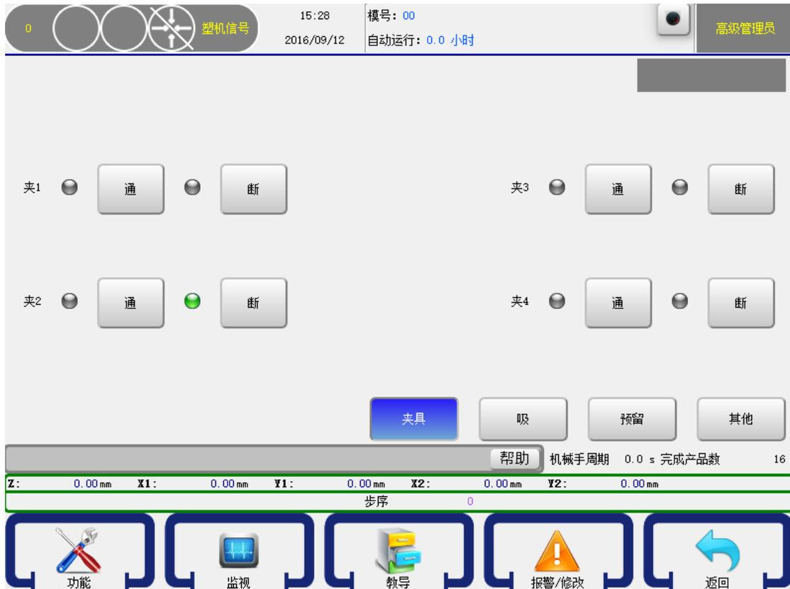
夹具有四组，点击按钮【通】即相应的夹具信号输出，点击按钮【断】即相应的夹具信号断开。
