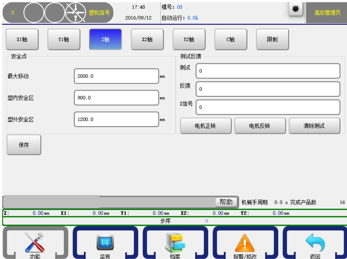
最大移动：设定Z轴移动的最大距离。
