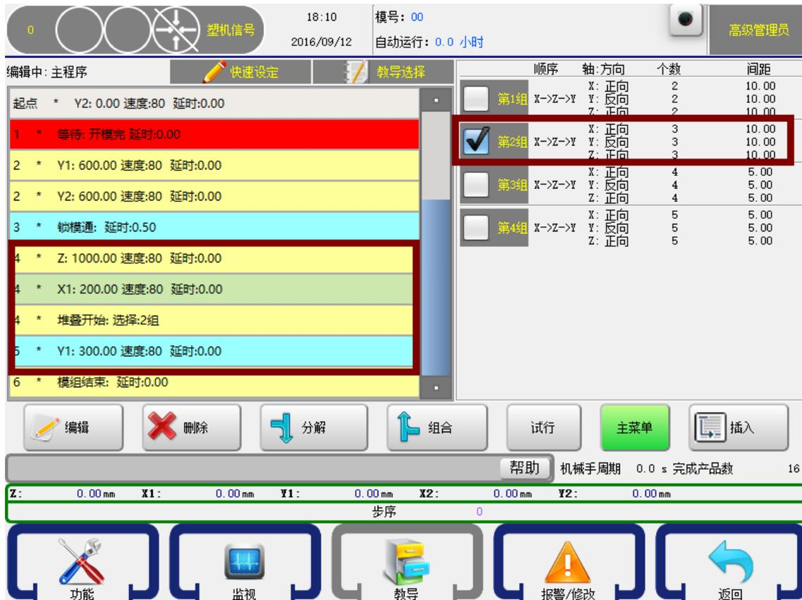
选中要插入的堆叠程序组左边的方框，如选择第 2 组堆叠程序，再点击【插入】按钮将该组堆叠程序插入到要开始堆叠的程序步前，自动运行时，机械手即按照此堆叠程序堆叠排放产品。如果要使用 Y 轴进行堆叠时，务必将堆叠程序插入到 Y 轴下降动作的前一步。
