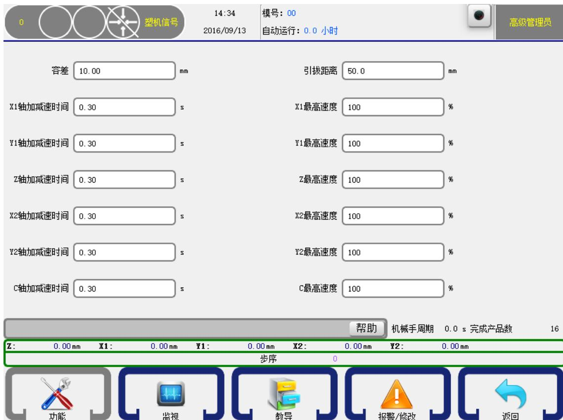
**容差：** 指令运行的距离与实际运行反馈回的距离之间的差值。**此参数不影响系统定位精度。**
