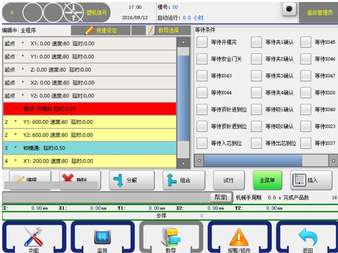
点击要等待输入信号左边的  使其变成图标 ，选中页面左边的程序步，再点击【插入】按钮即可将该等待输入信号插入到所选择程序步的前面。
