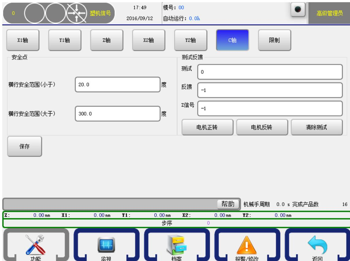
横行安全范围：横行动作时限制治具的安全角度。如上图数据，则（0-20；300-360 为 C 轴的横行安全范围【即水平状态】）
