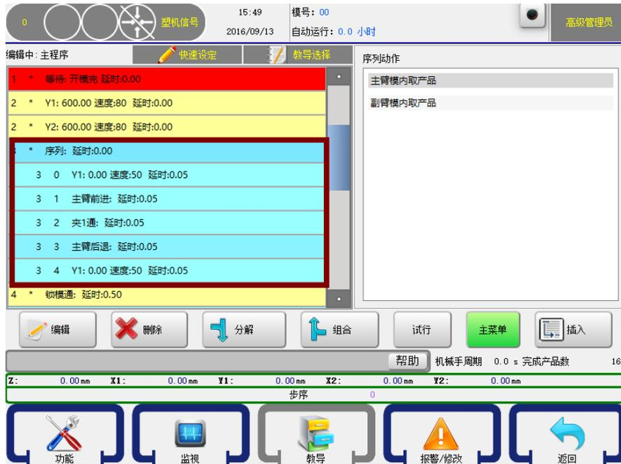
序列动作分主臂模内取产品和副臂模内取产品，如上图所示。此功能主要是将模内取产品的一系列动作作为 2 级程序，形成一个程序块。可以在此序列程序块中完成整个模内取产品的动作。
