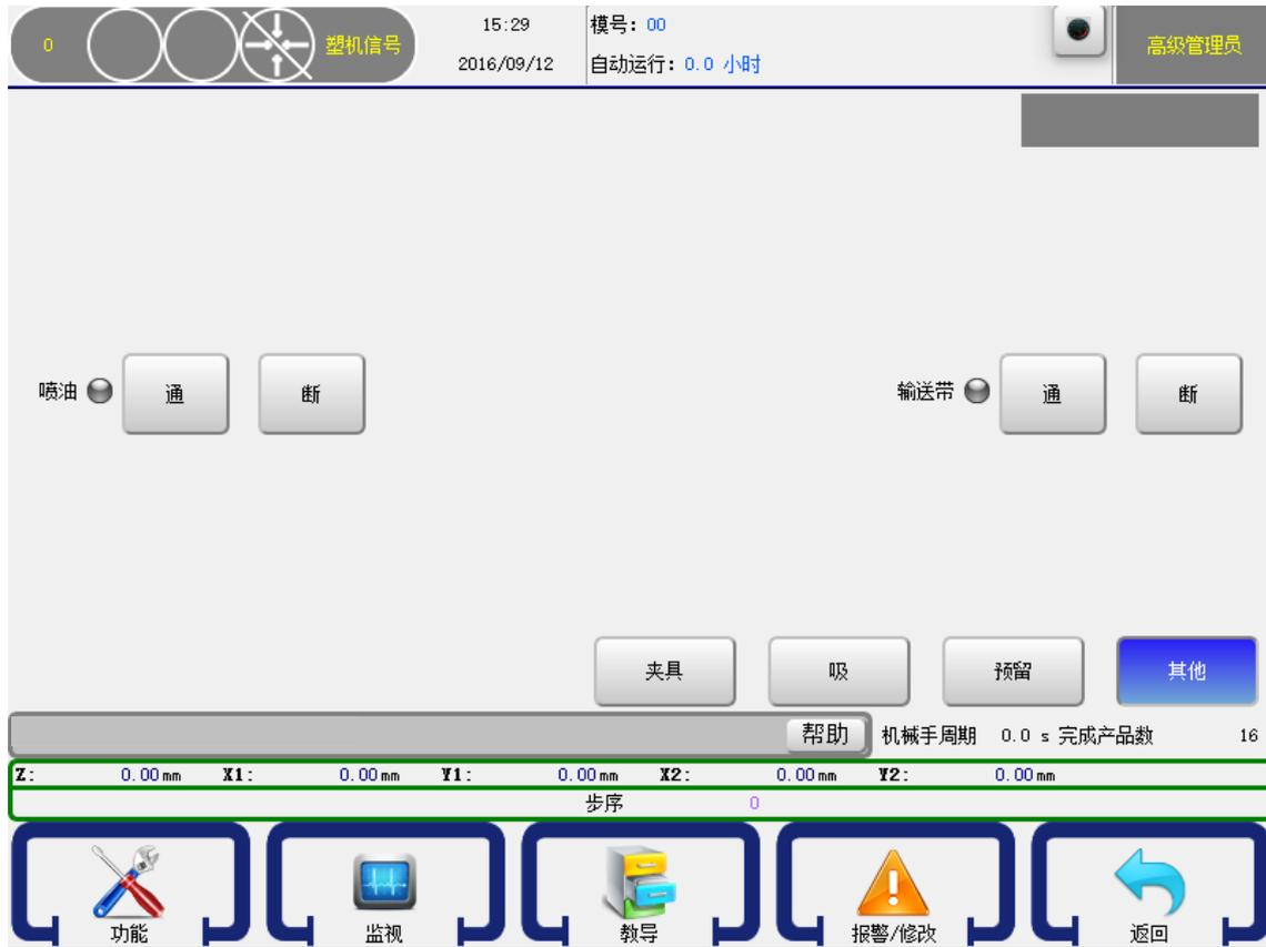
点击喷油按钮【通】即喷油输出点通，点击按钮【断】即喷油输出点断开动作。
