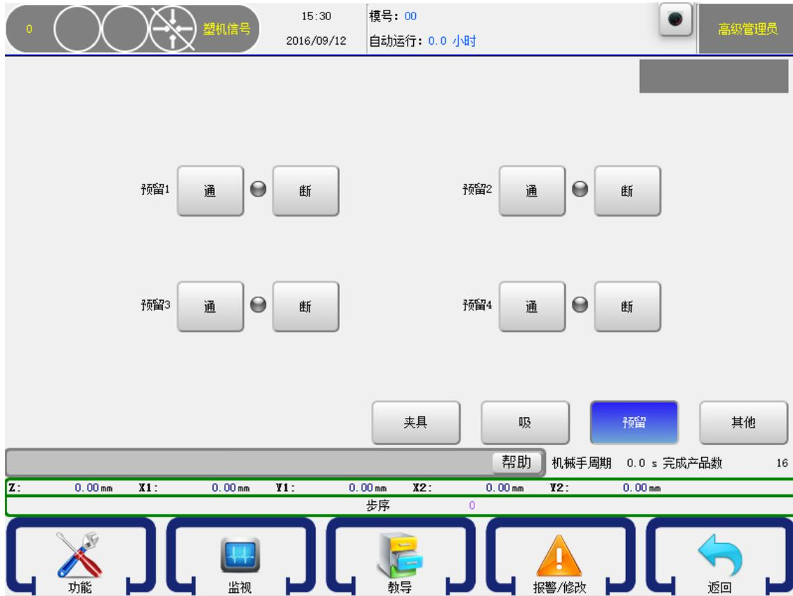
预留有四组，点击按钮【通】即相应的预留点信号输出，点击按钮【断】即相应的预留点信号断开。
