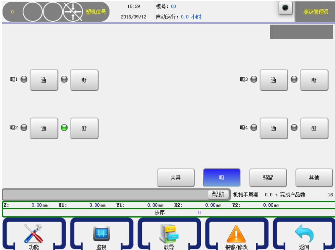
吸盘有四组，点击按钮【通】即相应的吸盘信号输出，点击按钮【断】即相应的吸盘信号断开。
