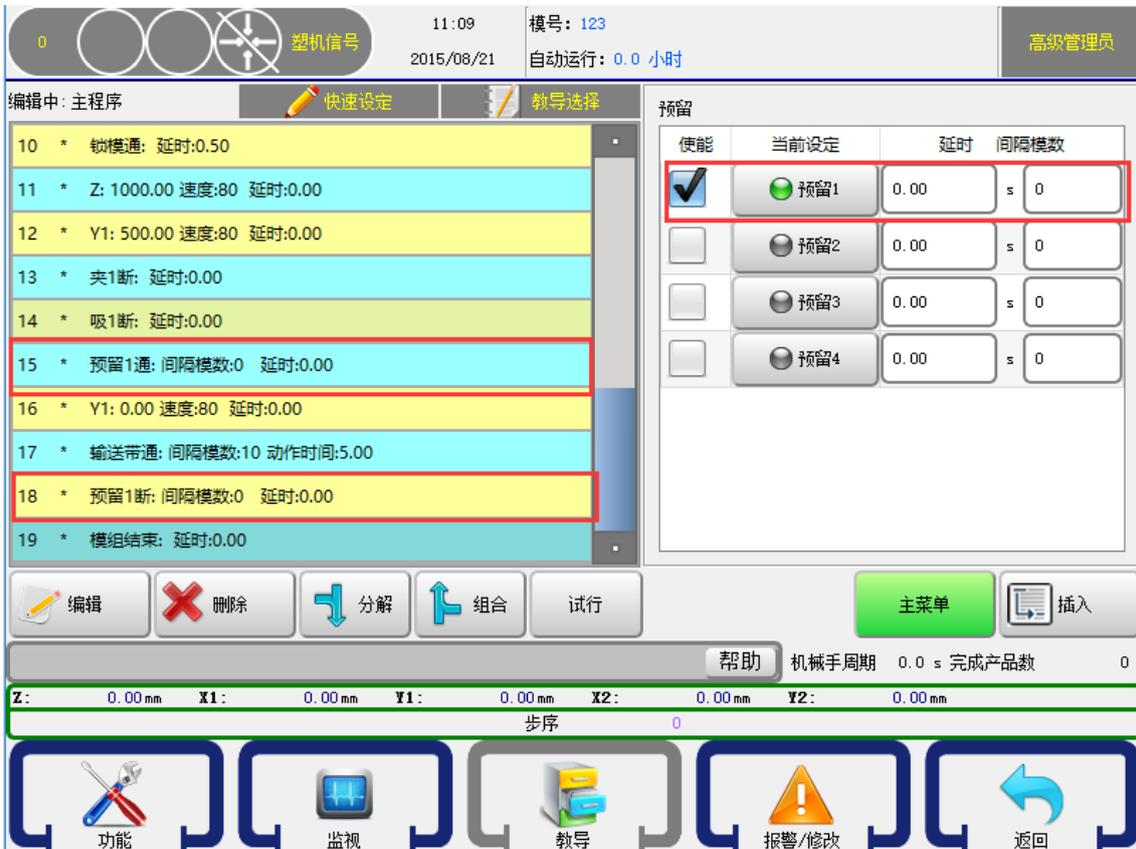
控制器可控制有四组预留动作，点击所要控制的预留按钮，该预留点即输出同时按钮上的指示灯即变成绿色。再点击左边的使其变成, 再点击【插入】按钮将该动作插入到所选择程序步的前面。
