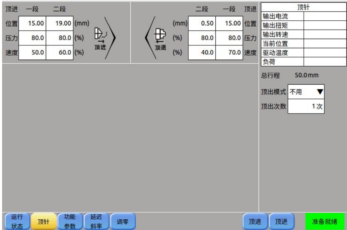
图 35 顶针动作参数页面
