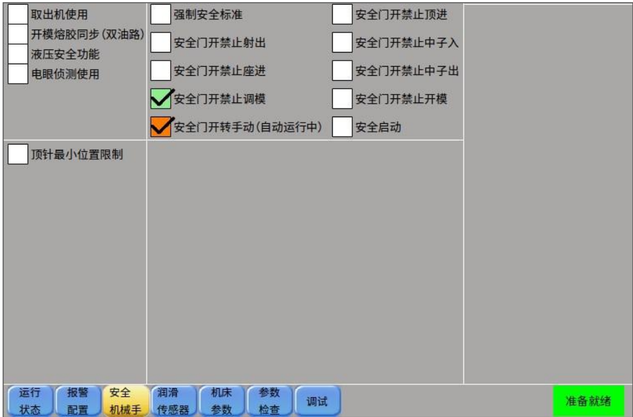
图 55 润滑/机械手/强制安全设置页面
