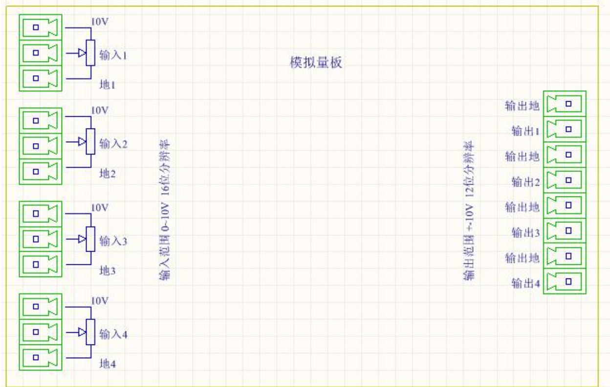
图 10 模拟量板接口定义
