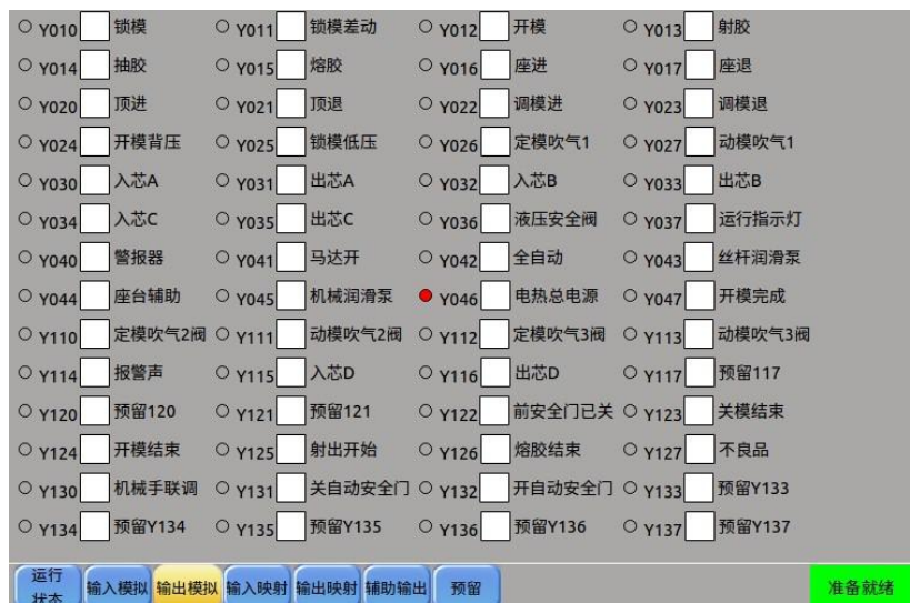
图 66 IO 输出模拟页面
