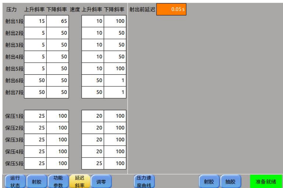
图 28 射胶延迟斜率页面
