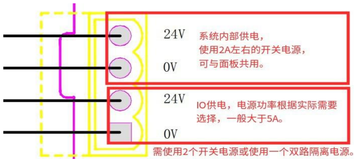
图 3 主机电源接线要求
